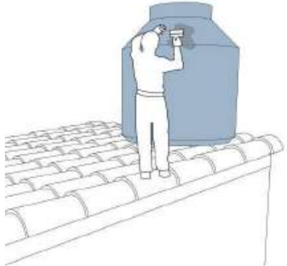
Reparación: Rellenado de fisuras en el tanque por personal calificado.
