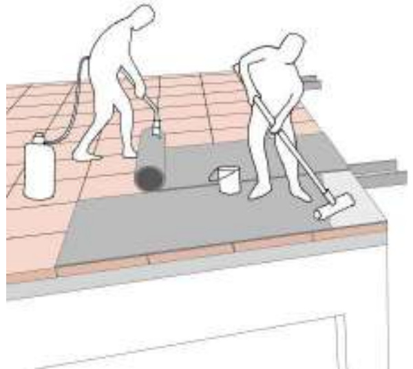
Mantenimiento: Impermeabilización geomalla.
